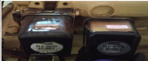
Suministro e instalación de filtro de aceite, combustible, aire incluye cambio de aceite de motor 15w40CI-4
