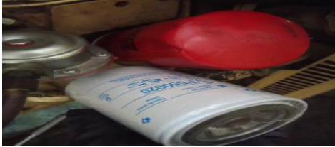
Suministro e instalación de filtro de aceite, combustible, aire incluye cambio de aceite de motor 15w40CI-4
